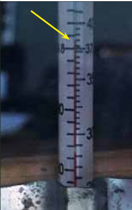
De waarde van staafthermometer t.o.v. dat van de Inkbird.
